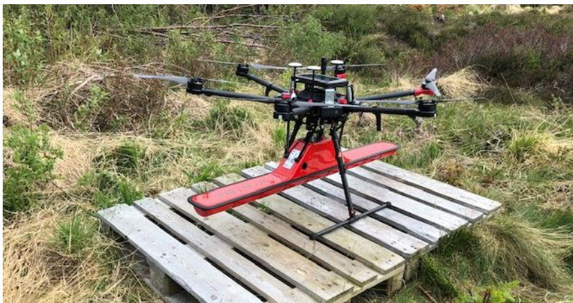
Figur 2: Drone med 80MHz GPR antenne
